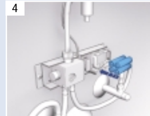
La mise en service démarre après la mise en place de la dernière pile (voir graphique en haut)
